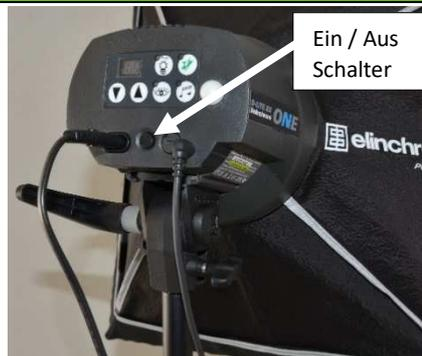
Schalte den Blitz an dem Schalter auf der Rückseite aus.
