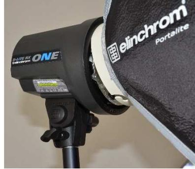
Nehme dann die Softbox und führe den Flansch von vorne in den Studioblitz ein. Achte dabei auf die Ausrichtung: Der „Elinchrom“-Schriftzug der Softbox muss dabei in einer Flucht mit dem Schriftzug des Studioblitzes liegen. Der Flansch muss dann im UZS eingerastet werden.
