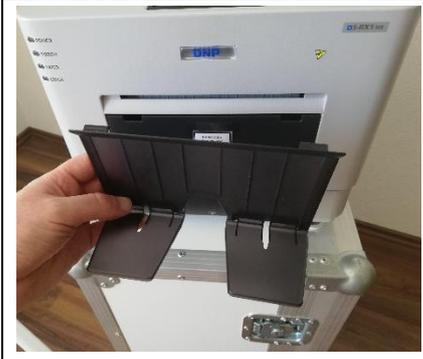
Hänge nun die Bild-Auffangschale an den 2 Öffnungen vorne am Papierreste-Auffangbehälter ein.
