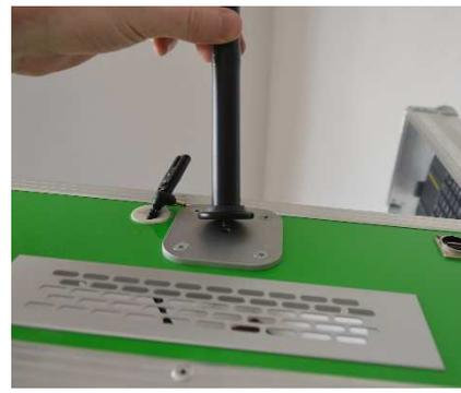
Nehme nun aus dem aufgeklappten Deckel der Fotobox das schwarze Blitzstativ und schraube es auf die Flanschplatte auf der Oberseite der Fotobox handfest auf. Achte beim Einschrauben auf eine senkrechte Ausrichtung, damit das Gewinde nicht beschädigt wird.
