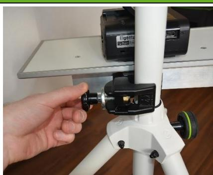
Hierzu einfach die Klemme wie auf dem Bild gezeigt ansetzen und die Klemmschraube handfest anziehen.
