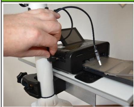
Anschließend nimmst du das abgewinkelte USB-Kabel und befestigst es an der USB-Buchse des Druckers.
