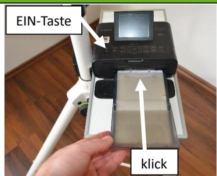
Klappe das Display des Druckers nach oben, öffne die Frontklappe und schiebe anschließend das geladene Papierfach von vorne bis zum Einrasten ein. Anschließend drückst du die EIN-Taste für ca. 3 Sek., bis der Drucker hochfährt (Canon-Logo erscheint).
