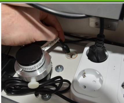
Im nächsten Schritt führst du das Stromkabel des Druckers durch die Kabeldurchführung in der Fotobox bis zum Drucker.
