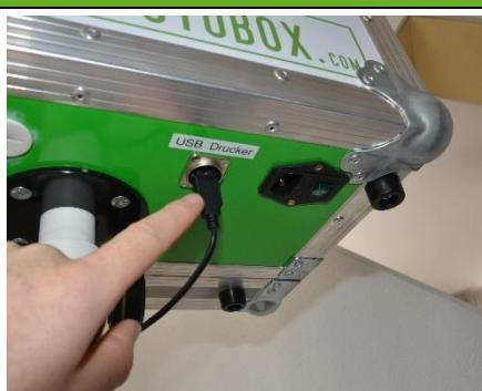
Als nächstes führst du das USB-Kabel auf der Unterseite der Fotobox in die USB-Buchse ein.
