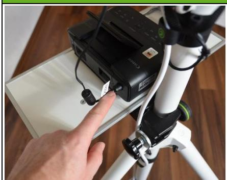
Stecke dann das Stromkabel auf der Rückseite des Druckers in die vorgesehene Buchse.
